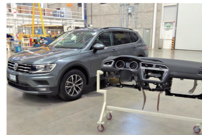
森六の主力製品は、樹脂成形による自動車向けの内外装部品。上はメキシコでフォルクスワーゲンのために生産している内装部品
