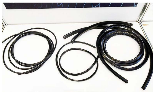
CNTマスターバッチを添加した導電シリコンゴム押出品
