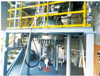
3基目の乾燥設備導入も視野 （写真は真空ろ過乾燥機）
