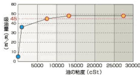
ムース油の吸油量 試験方法(当社測定法)
